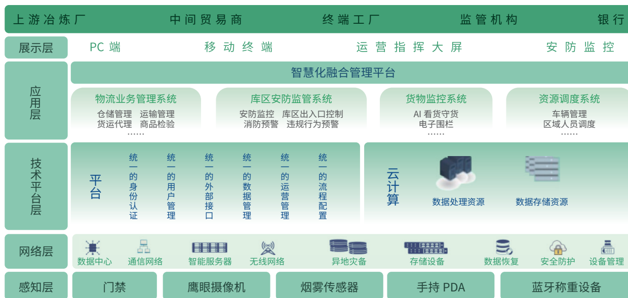
图 3: 样板交割仓库智慧化建设方案技术架构图示
